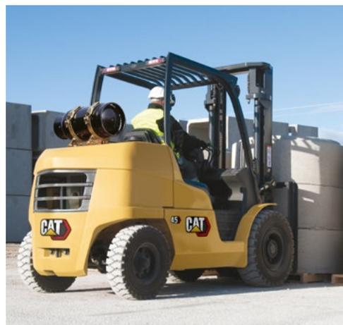
Il modelli GP40-GP55N3 sono equipaggiati con il motore GPL GCT GK45 con depuratore catalitico di serie che offre buone prestazioni, eccellente razionalizzazione del carburante, basse emissioni di scarico, bassi livelli di vibrazioni e rumorosità.
